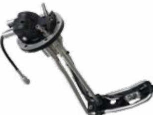
SCR传感器 SCR传感器用于测量尿素的温度，液位和品质，同时还提供多种与冷却剂回路连接的加热器。
